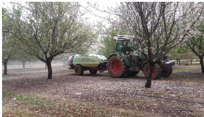
Figura 26. Aplicación de productos fitosanitarios en almendro mediante un pulverizador hidroneumático.
